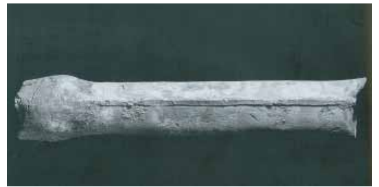
70 cm lange loden restant van waterleiding
